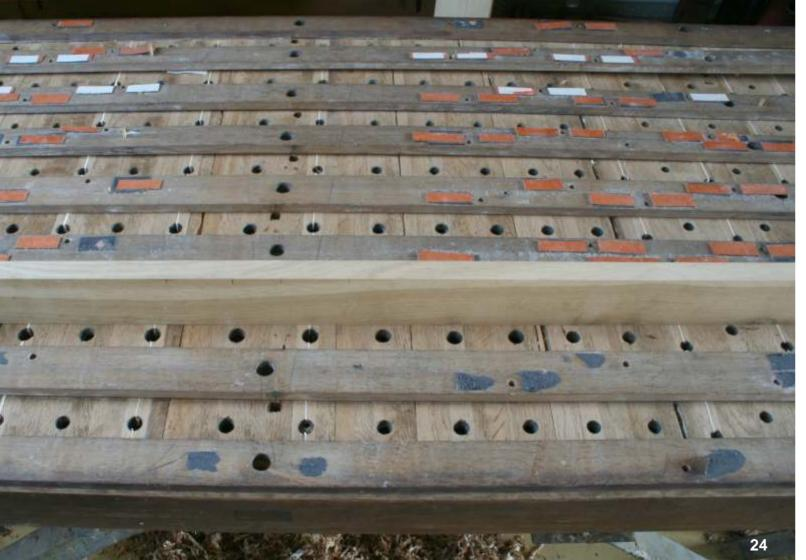
Um künftige Trocknungsschäden an den wertvollen Bauteilen zu verhindern, wurden die Windladen im Zuge der Restauration mit entsprechenden Dehnungsfugen versehen. Diese erlauben in einem gewissen Rahmen ein Trocknen und Quellen des Holzes, ohne dass hierdurch die Windkanzellen in Mitleidenschaft gezogen werden.
